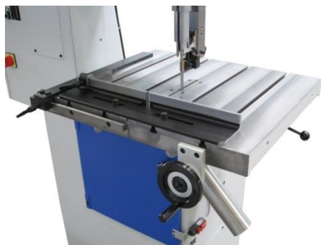
Manueller Vorschubtisch SSF420, mit Gewindespindel
