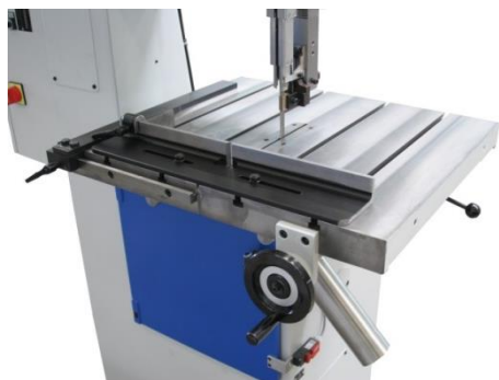
Manueller Vorschubtisch SSF420, mit Gewindespindel
